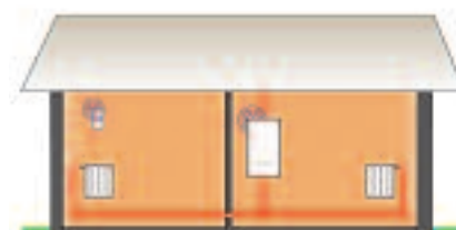
Installation avec circuit radiateurs
